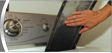
La principal causa de incendios por secadoras es la falta de limpieza. Pueden ocurrir incendios si hay una acumulación de tela o pelusa en los conductos de ventilación de aire, los cuales pueden sobrecalentarse y causar un incendio.
